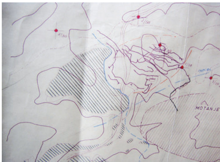
Izsek iz karte »Situacija jamskih del in vrtin rudnika Šega – Makole« (vijolične linije označujejo proge in vpadnike, rdeči krožci izvedene vrtine, s šrafuro je označen predoligocen in belo terciar) (Hamrla, 1962).
