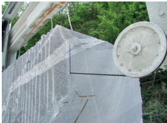
Na posnetku je vidno, kako z diamantno žago režejo ploščo od samega bloka granodiorita (foto: Marjan Šenica, 30. 4. 2011).
