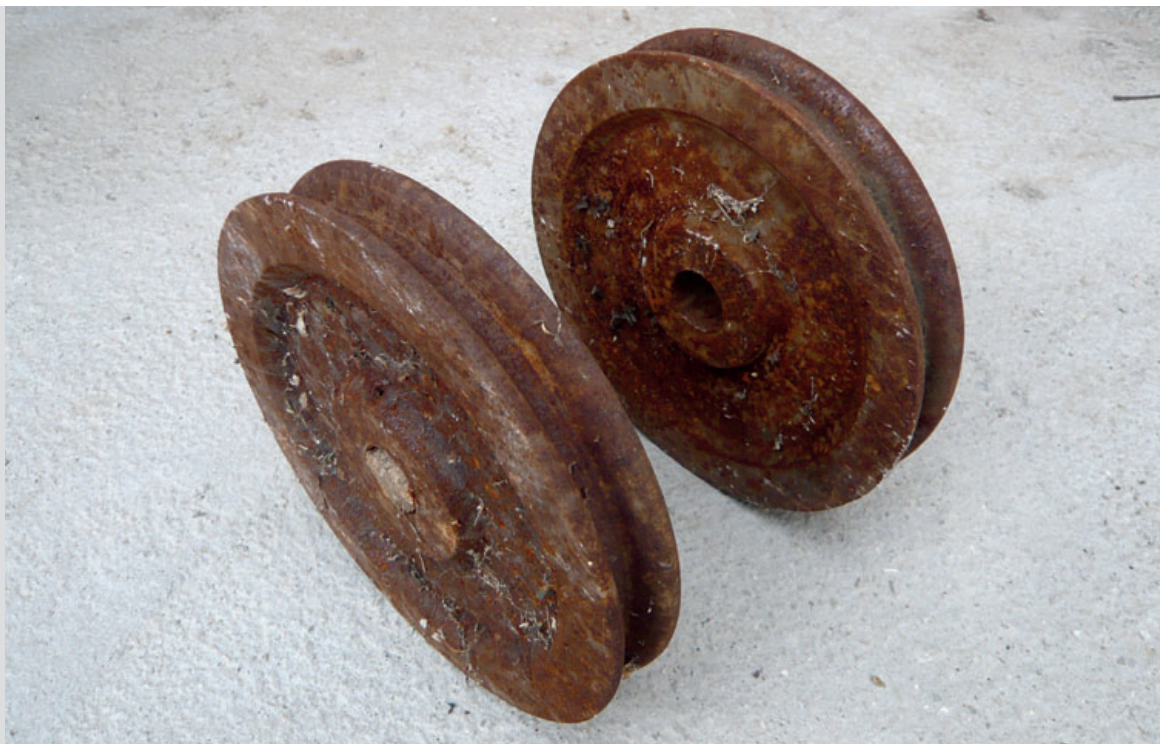
Med zadnjimi ostanki premogovništva na Zreškem sta dve jekleni kolesi z utorom škripca žičnice, ki je povezovala rudnik na Brinjevi gori z Zrečami. Betonski opornik žičnice je še ohranjen pri sedanjih bencinskih črpalkah v Zrečah. Kolesi je pred uničenjem rešil Ivan Podgrajšek iz Zlakovce (foto: Vito Hazler, 15. 3. 2011).
