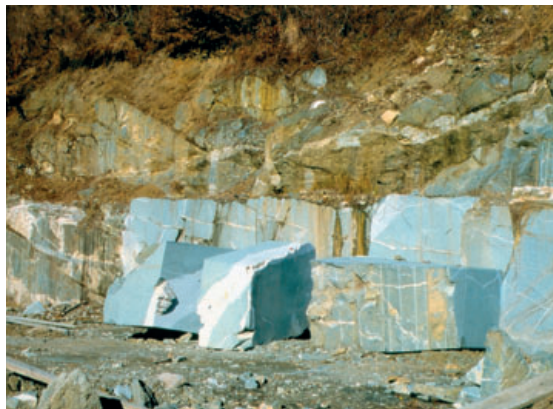
Na posnetku iz leta 1998 vidimo zadnje odrezane bloke čizlakita ob sami etaži, ki je bistveno nižja kot v sosednjem kamnolomu (foto: Viljem Podgoršek, 28. 4. 1998).
