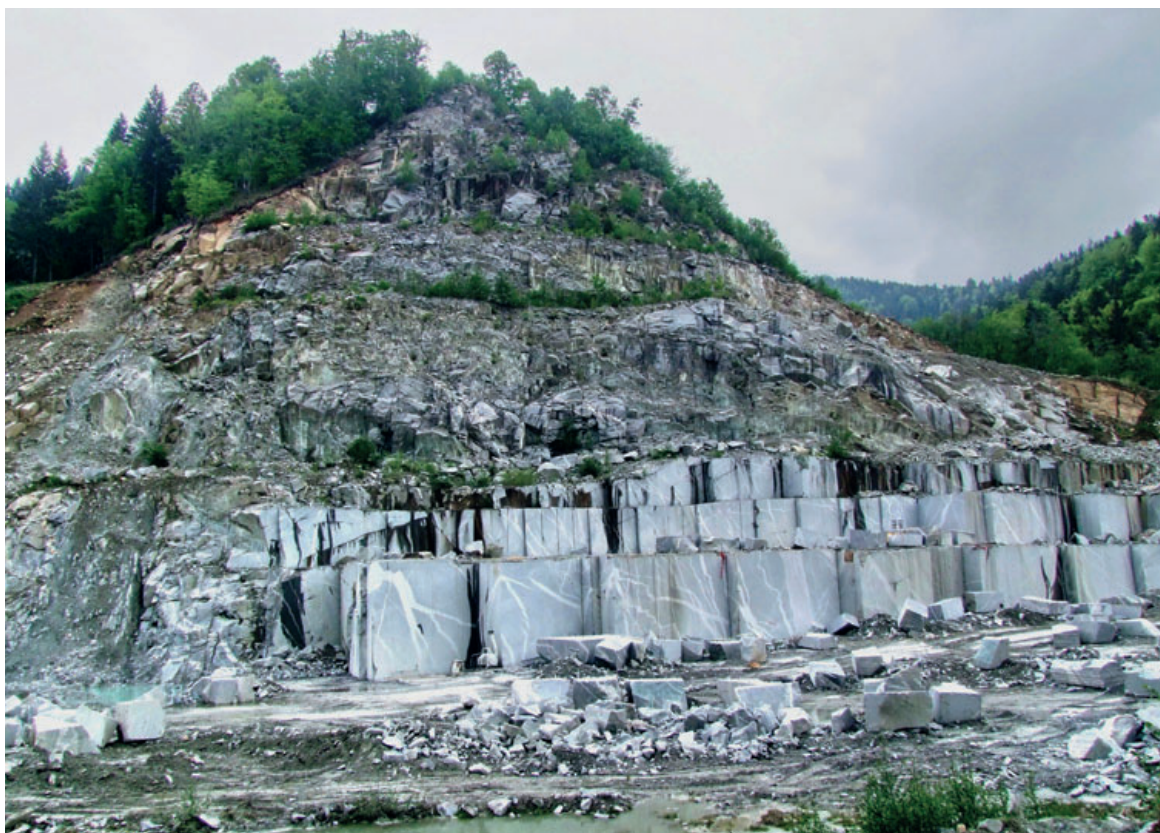
Takšen je dandanes pogled na celoten kamnolom. V zgornjem delu so nekoč kamnino pridobivali z odstreljevanjem, v spodnjem, kjer je kompaktnejša, pa pretežno z žaganjem (foto: Marjan Šenica, 1. 5. 2011).
