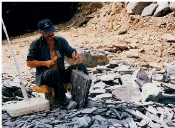
Večje kose gnajsa so najprej prečno razlomili v manjše, potem so jih z dleti in kladivi razklali v želeno obliko (foto: Viljem Podgoršek, 13. 6. 2002).
